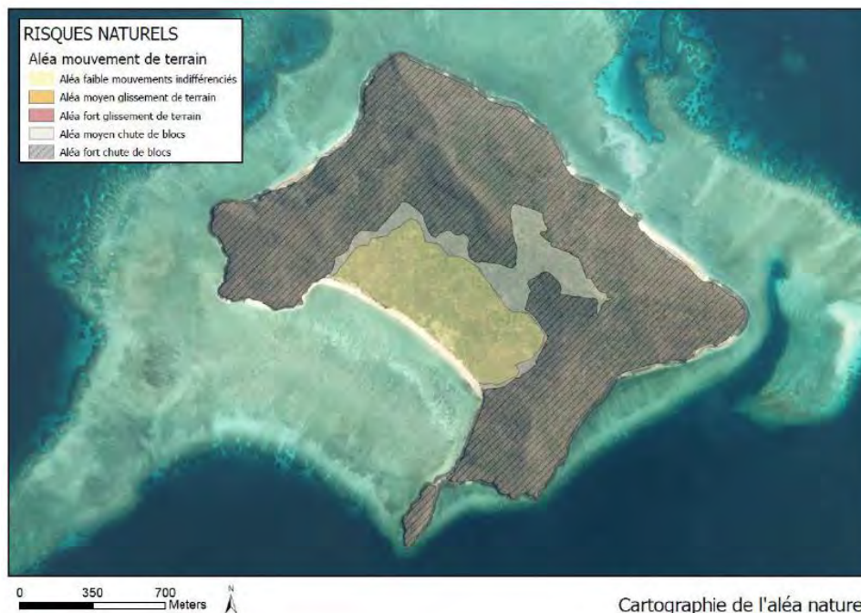
Figure 8 : Extrait des PPRN de la Commune de Mtsamboro - Aléa mouvement de terrain
