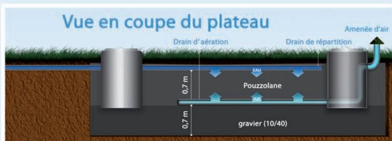
La mise en place du puits bactérien filtrant pour les parcelles d'une superficie inférieure à 250 m<sup>2</sup>, nécessitant une dérogation de la DASS (Direction des Affaires Sanitaires et Sociales).
