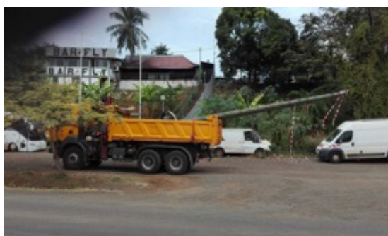
Type de chargement dangereux et interdit
