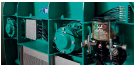
Système de graissage automatique muni de 4 pompes programmables et indépendantes
