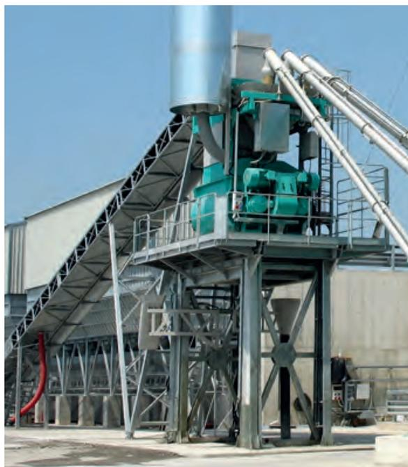
Groupe de malaxage ORULK 100-120-125-130 avec tapis convoyeur de chargement et trémie d'attente des agrégats
