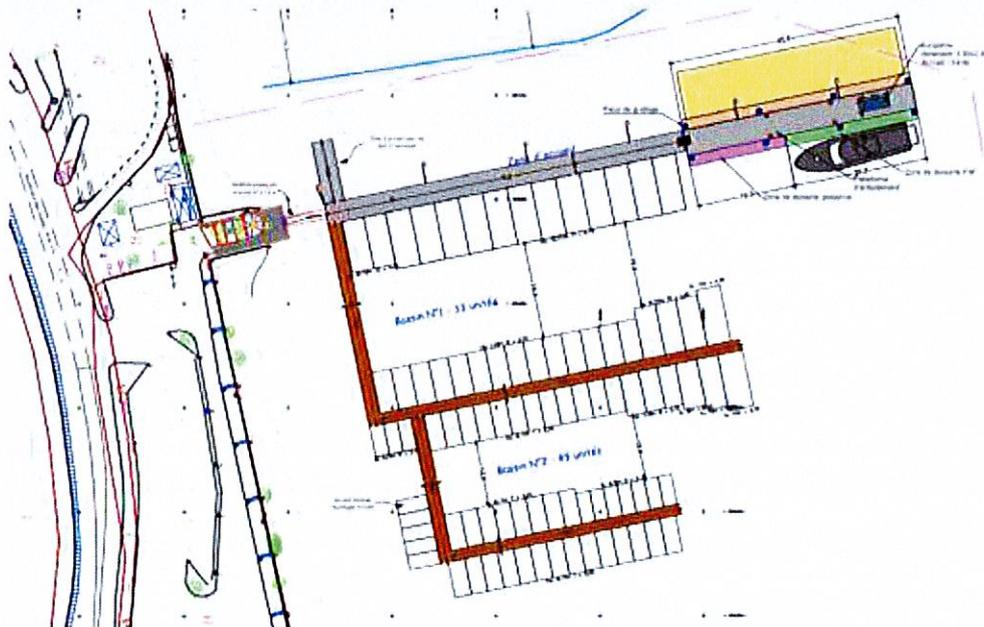
Port de Dzaoudzi – projet : pontons flottants lourds, brise-clapot ou non, pour protection du plan d'eau et pontons flottants légers, aluminium et bois, pour amarrage des navires
