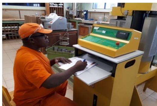
Mesure de résistance à la rupture d'un béton
