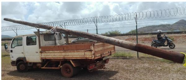
Dépassement avant interdit et arrière trop long et mal signalé
