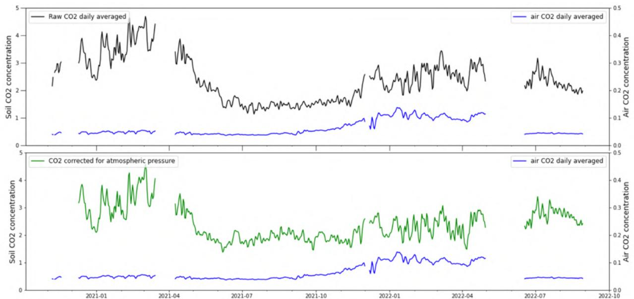
Figure 11 : Concentration en CO<sub>2</sub> dans le sol à la station permanente UDMN. Comparaison entre les données brutes (noir) et les données corrigées de l'influence de la pression atmosphérique (vert). Bleu : concentration dans l'air (1 m au-dessus du sol). Les variations de concentrations dans l'air sont liées à l'activité biogénique (©OVPF-IPGP / REVOSIMA).
