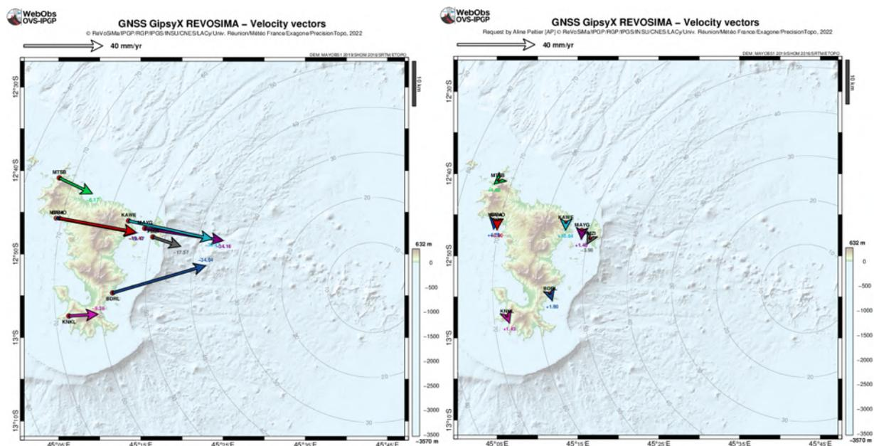
Figure 7 : Déplacements du sol enregistrés sur les stations GPS de Mayotte depuis le 1<sup>er</sup> juillet 2018 (à gauche) et sur les derniers douze mois (à droite). Les déplacements horizontaux sont représentés sous forme vectorielle et les déplacements verticaux sont indiqués par les valeurs chiffrées en couleur. Post-traitement de ces données réalisé par l'IPGP (©OVFP-IPGP / REVOSIMA).
