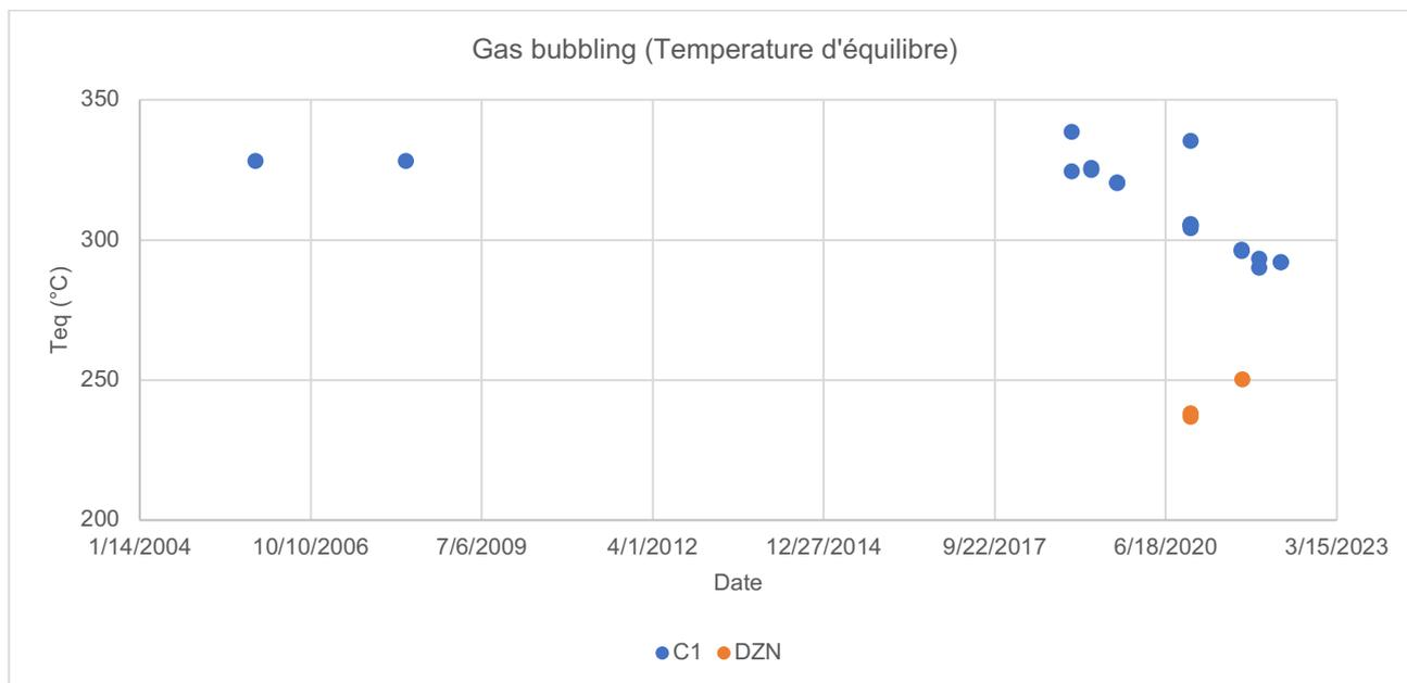
Figure 14 : Température d'équilibre des fluides au sein du système hydrothermal. La température d'équilibre entre le CO<sub>2</sub> et le CH<sub>4</sub> dans le système hydrothermal est estimée à l'aide de l'équation de Giggenbach 1992.
