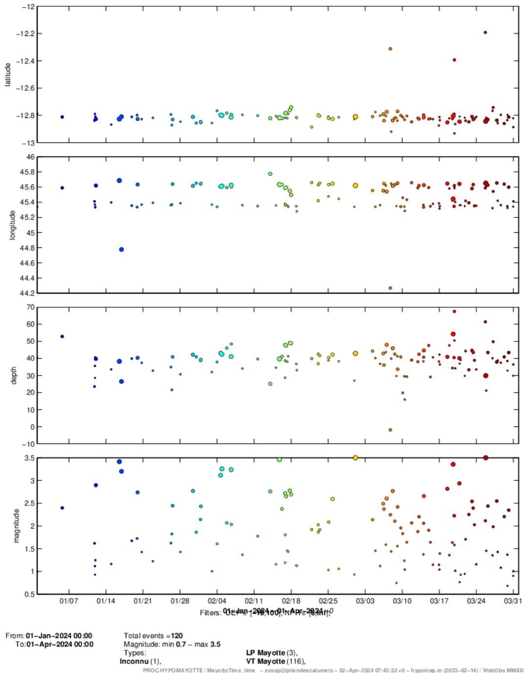
Figure 4 : Variation temporelle (échelle de couleur) des principaux paramètres (latitude, longitude, profondeur et magnitude) de la sismicité enregistrée et localisée par le REVOSIMA avec les réseaux sismiques à terre (IPGP-CNRS-BRGM-BCSF-RENAISS, ITES) entre le 1<sup>er</sup> janvier 2024 et le 31 mars 2024 (3 mois). Se référer à la Figure 2 pour l'échelle des magnitudes (taille des symboles). (© OVPF- IPGP, BRGM, IFREMER, CNRS, BCSF-RENAISS, ITES / REVOSIMA).
