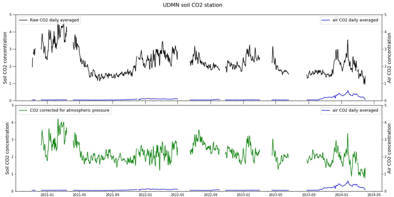
Figure 12 : Concentration en CO<sub>2</sub> dans le sol à la station permanente UDMN. Comparaison entre les données brutes (noir) et les données corrigées de l'influence de la pression atmosphérique (vert). Bleu : concentration dans l'air (1 m au-dessus du sol). Les variations de concentrations dans l'air sont liées à l'activité biogénique (©OVPF-IPGP / REVOSIMA).
